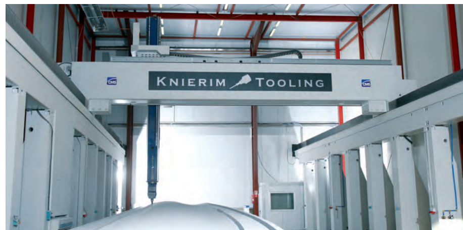
Große CMS-Fünf-Achs-Fräse von KNIERIM beim Schlichten eines Urmodells
